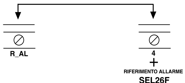
□ Fig. 4.1. Collegamento del morsetto R_AL della centrale al morsetto di comando della sirena autoalimentata mod. SEL26F.
