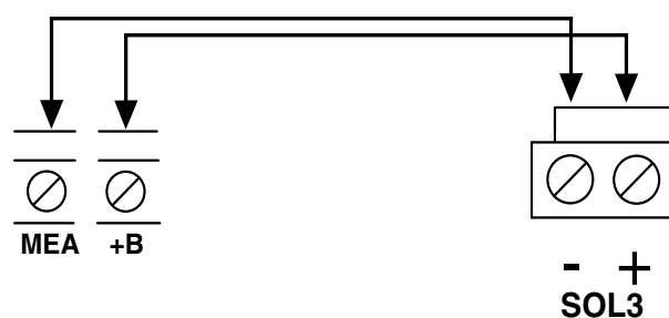
□ Fig. 8.1. Collegamento antisabotaggio di un rivelatore (IR100), alla linea L24h.
