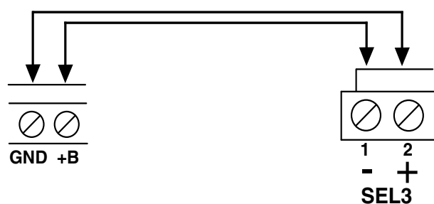
□ Fig. 4.1. Collegamento del morsetto R_AL della centrale al morsetto di comando della sirena autoalimentata mod. SEL26F.
